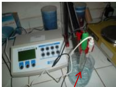
Photo 8 : Mesure de la température et du PH à l'aide d'un multimètre de marque HANNA
