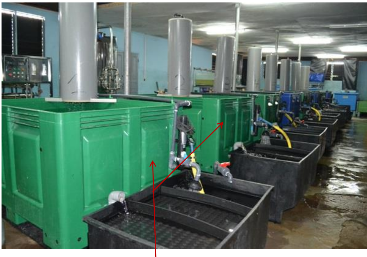
Photo 2 : Circuits fermés dans l'écloserie du MINEPIA à Logbaba (MINEPIA, 2015)
