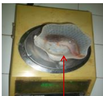
Photo 12 : Mesure du poids des alevins à l'aide d'une balance sensible à 0.01g
